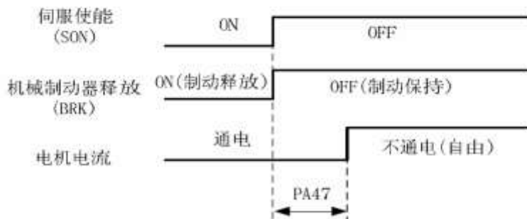
图 16-7: 电机停止时机械制动器动作时序
