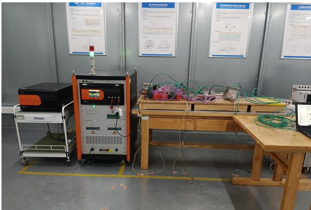
图 68 交流电压暂降、短时中断的抗扰度试验布置图
