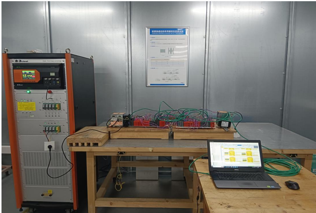
图 50 浪涌(冲击)抗扰度试验布置图
