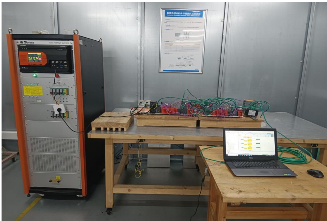
图 48 电快速瞬变脉冲群抗扰度试验布置图
