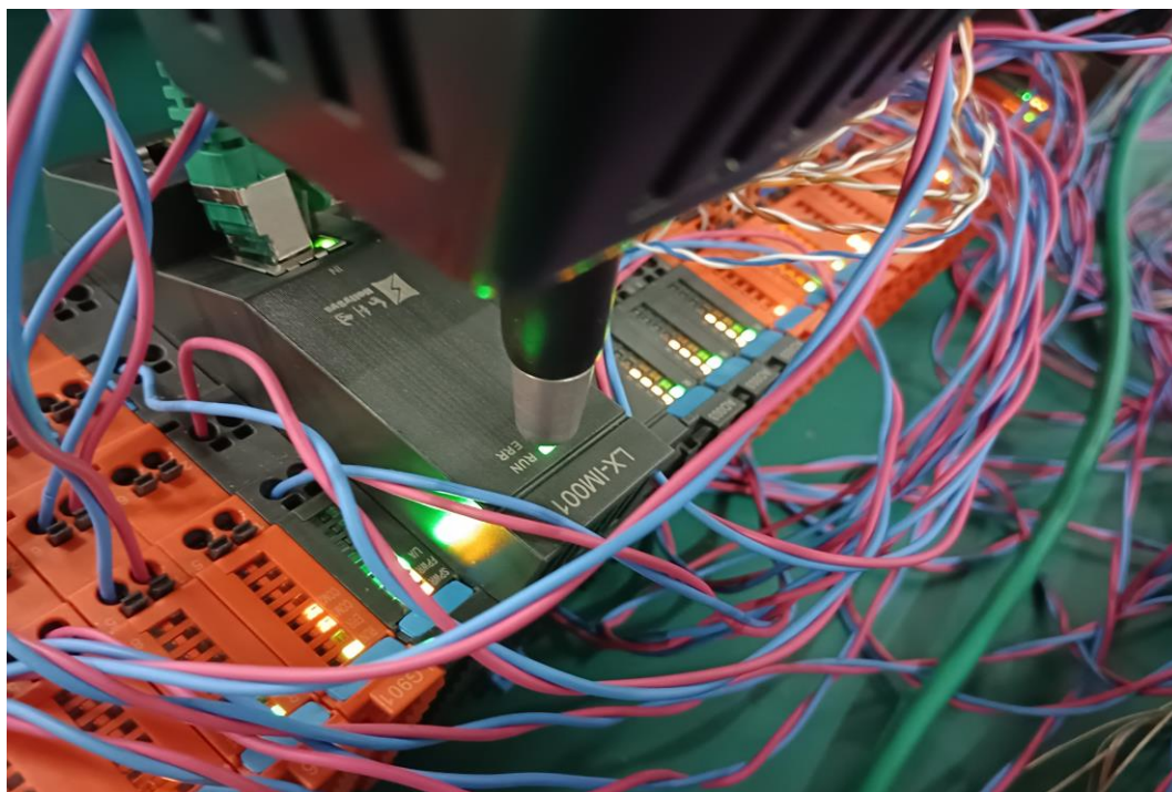
图 27 静电放电抗扰度空气放电试验图-2
