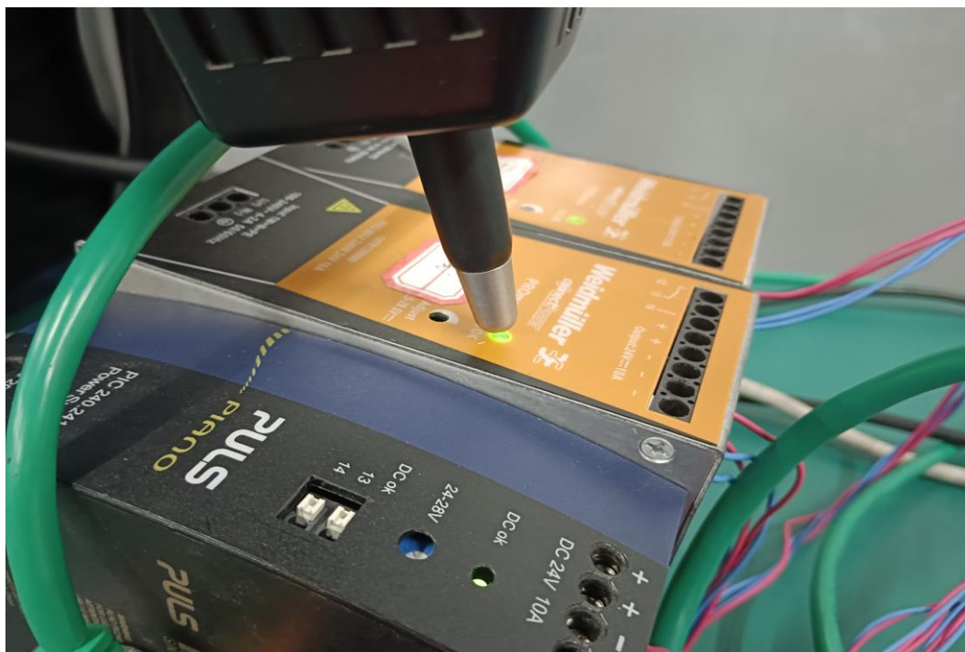
图 26 静电放电抗扰度空气放电试验图-1
