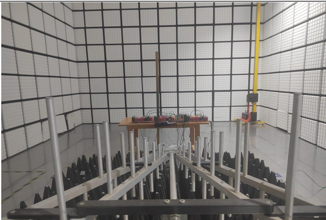
图 44 80MHz~1GHz 射频电磁场辐射抗扰度试验布置图
