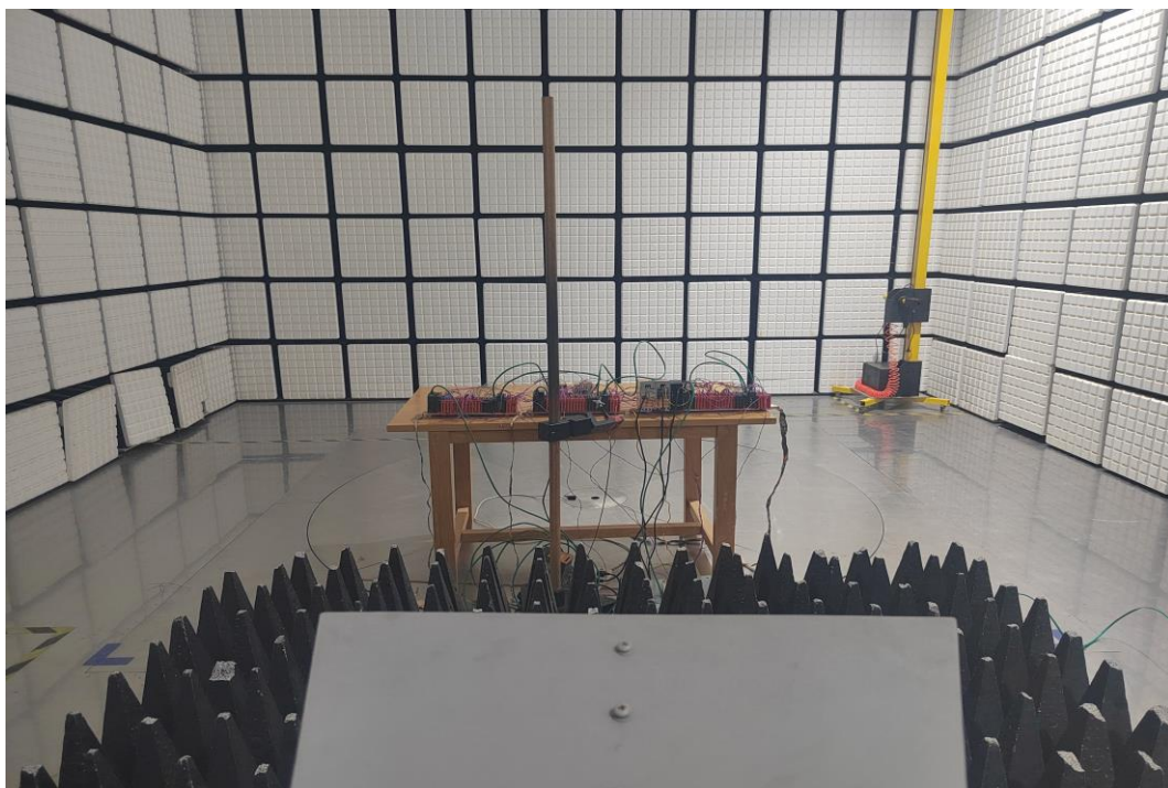
图 46 2.5GHz~6GHz 射频电磁场辐射抗扰度试验布置图
