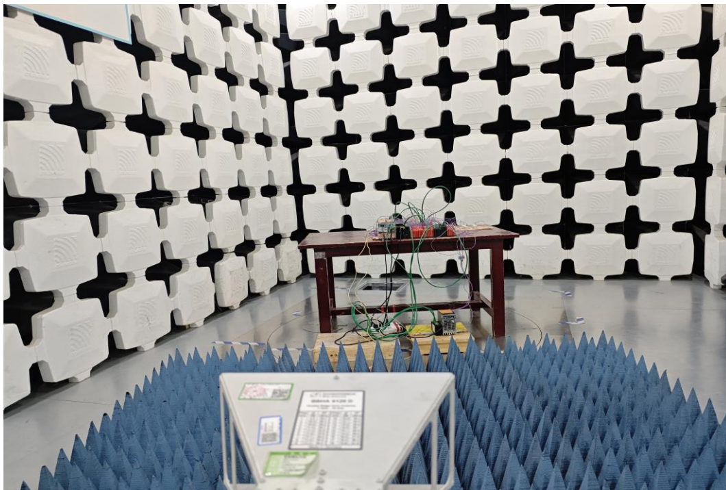
图 21 1GHz~6GHz 辐射骚扰试验布置图
