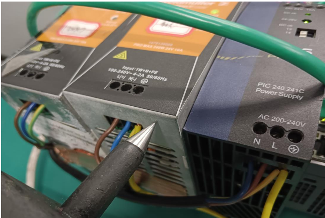
图 25 静电放电抗扰度接触放电试验图-3
