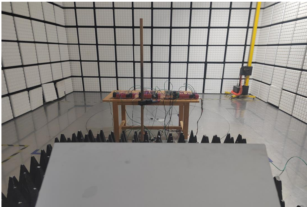
图 45 1GHz~2.5GHz 射频电磁场辐射抗扰度试验布置图
