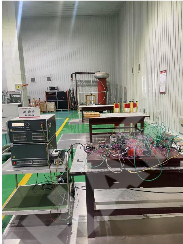
图 CCD01 0Hz-150kHz 共模传导骚扰抗扰度试验照片
