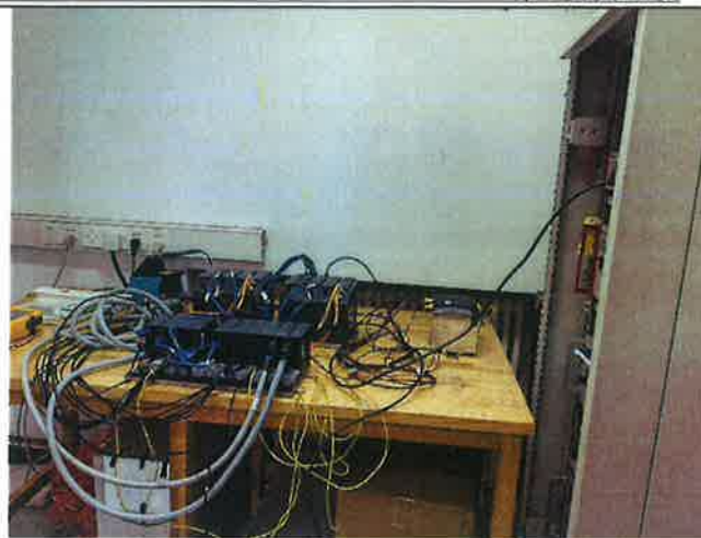
图8 电压暂降与短时中断抗扰度试验配置图
