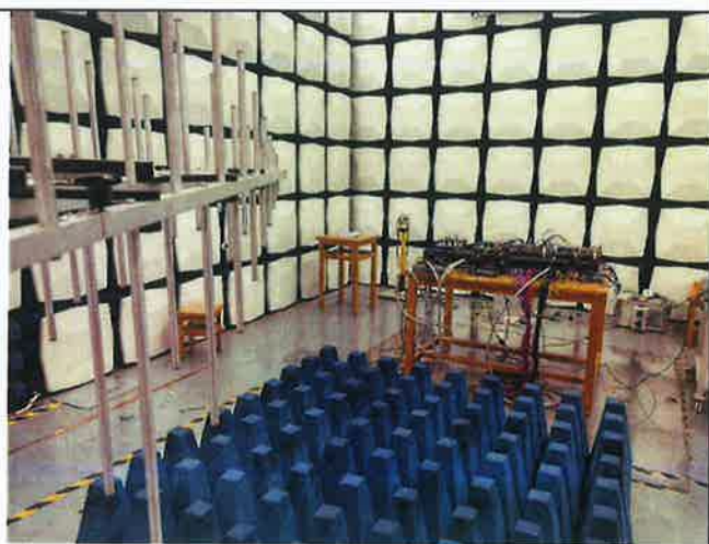
图2 射频电磁场辐射抗扰度试验配置图 ( 80MH ~ 1GHz )
