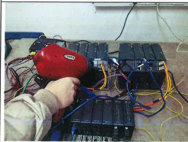
图1 静电放电抗扰度试验配置图
