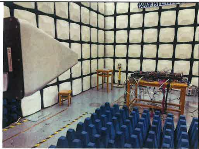
图3 射频电磁场辐射抗扰度试验配置图 ( 1GHz以上 )
