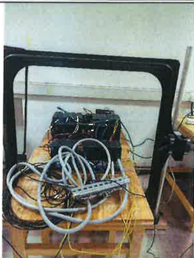
图7 工频磁场抗扰度试验配置图
