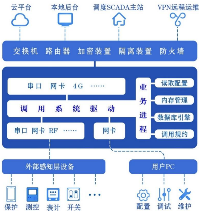
图 1-3 通讯管理机工作原理图
