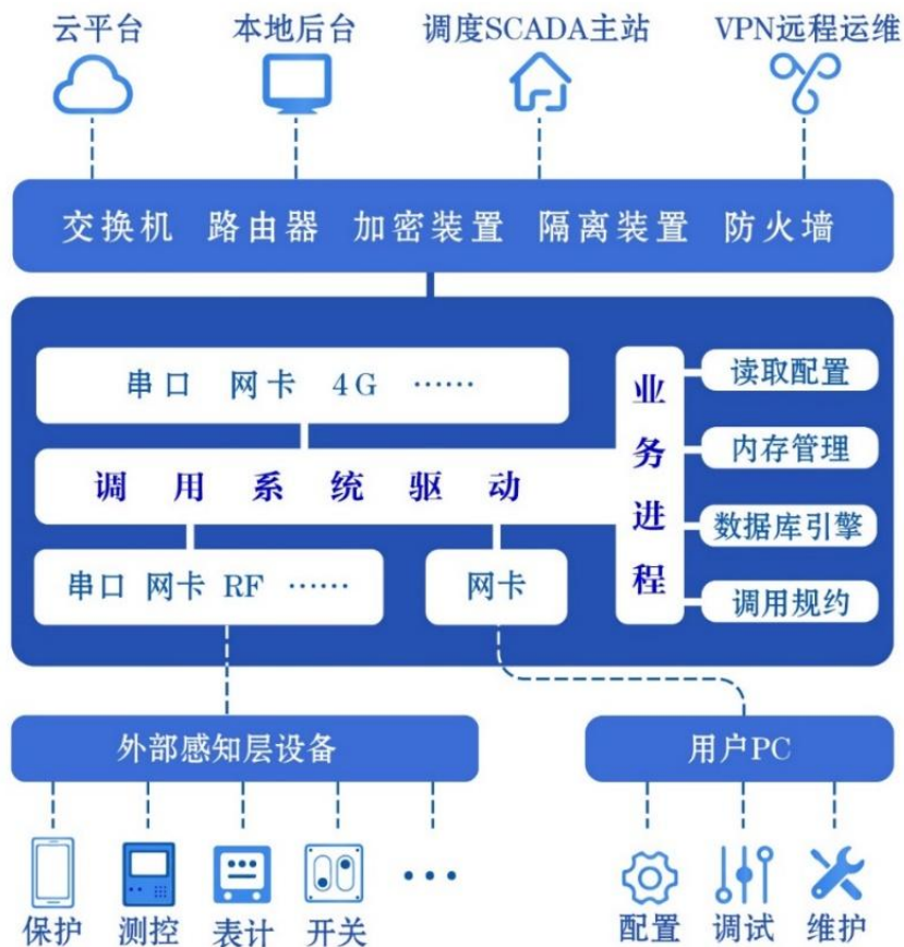
图 1-2 通讯管理机工作原理图
