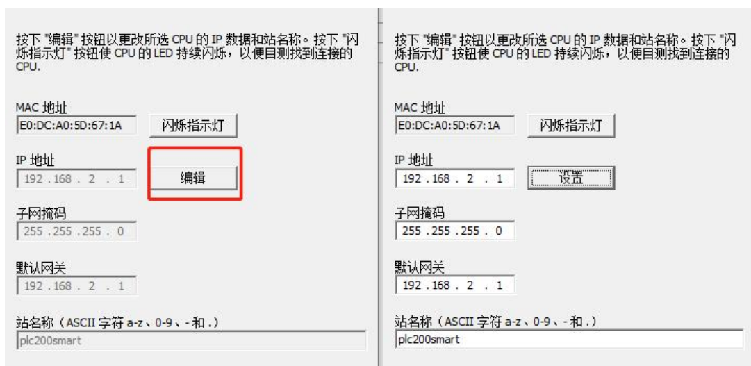
图 35 设置 PLC 设备 IP 地址及名称
