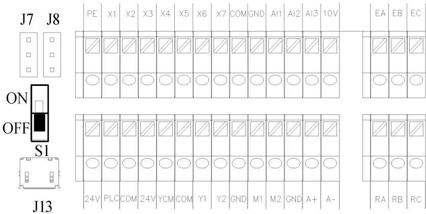
图 3-6 控制回路端子排列
