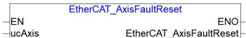
EtherCAT_AxisFaultReset Functional Block
